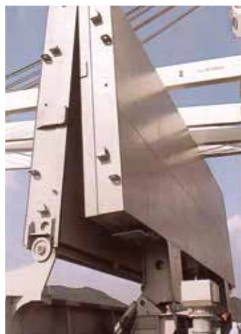
Гидравлические домкраты для открытия/закрытия крышек люков
