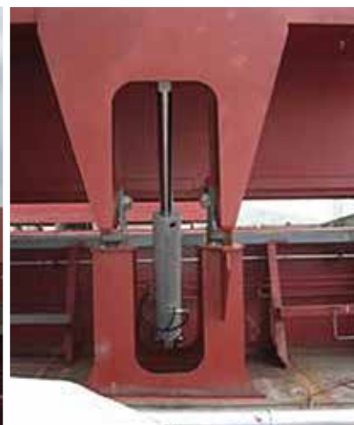
Гидравлические домкраты для открытия/закрытия крышек люков
